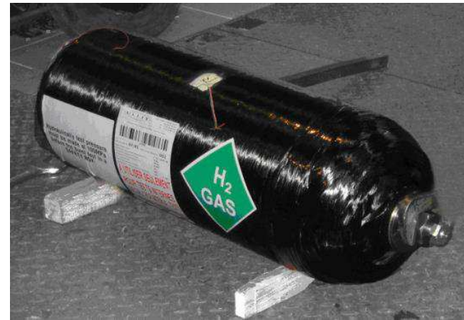
Wysokociśnieniowe zbiorniki kompozytowe do gromadzenia wodoru, J. Kaleta, P. Gąsior
